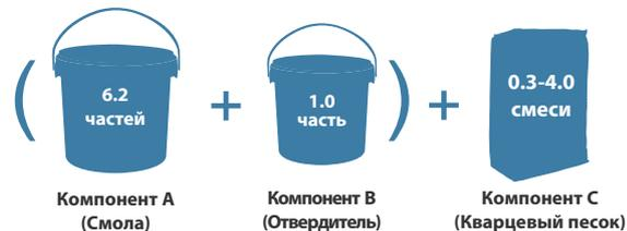
Состав поставляется в заводской дозированной упаковке, содержащей требуемое количество **компонента «А»** (смола), **компонента «В»** (отвердитель) и **компонента «С»** (наполнитель).
