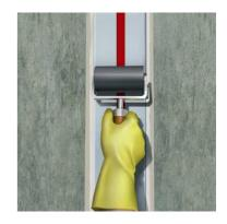
При работе с навесными или сложными конфигурациями ленту можно временно фиксировать в нужном месте при помощи клея  ${\sf Sika}^{\sf ®}$  Trocal Adhesive С-705. При этом данный клей можно наносить только на центральную часть ленты и ни в коем случае не на участки, которые будут приклеены клеем Sikadur® -31 CF.
