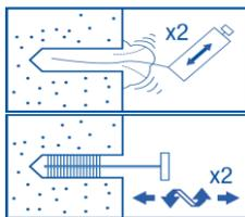
Шаг 2 Тщательно очистите отверстие в указанной ниже последовательности, используя для этого щетку с нужными удлинителями и насос для продувки. Последовательность выполнения чистки отверстия: Продувка x2 -> Чистка щеткой x2 -> Продувка x2 -> Чистка щеткой x2 -> Продувка x2.
