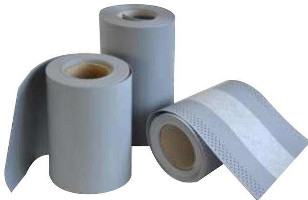
Концы ленты можно скреплять полимерным клеем с нахлестом не менее 100мм и сваривать специальным строительным феном, например Leister TriacAt. Для достижения максимального эффекта лучше сваривать ленту до приклейки на шов. Требования по сварке: температура 340°C, сила воздуха на отметке 3, используйте насадку 20 или 40 мм, делайте нахлест ленты не менее 100мм. Перед сваркой зачистите концы ленты наждачной бумагой.
