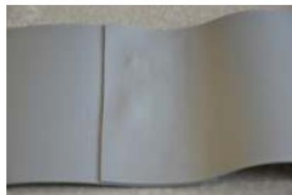
В результате сварки должен получиться монолитный шов.
