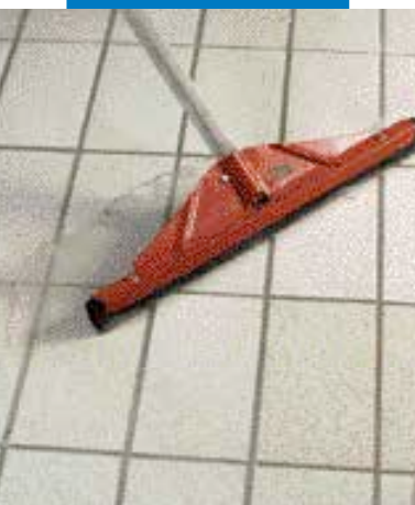
Удаление остатков жидкости резиновым ракелем
